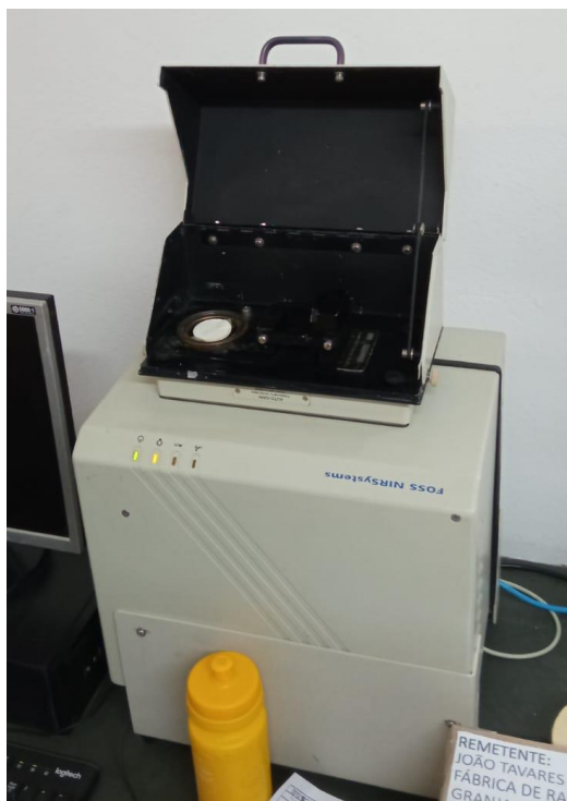
Figura 24 - Equipamento de análise NIRS.
