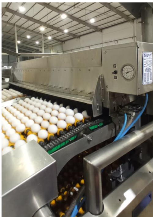
Figura 20 - Aplicação de óleo mineral sobre a casca dos ovos.
