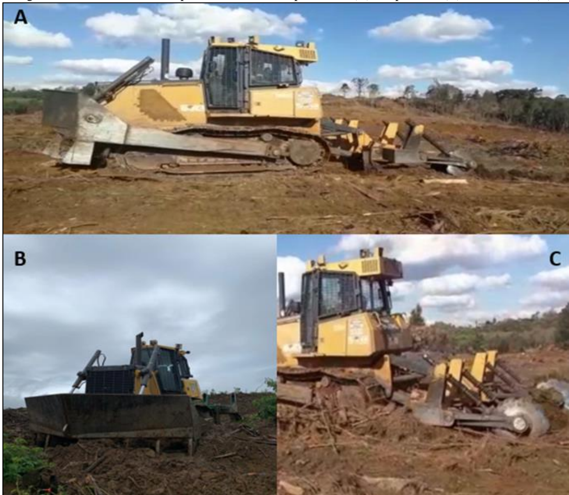
Figura 3 - Trator de esteira acoplado com os dois implementos (A), limpa trilho (B) e subsolador (C).
