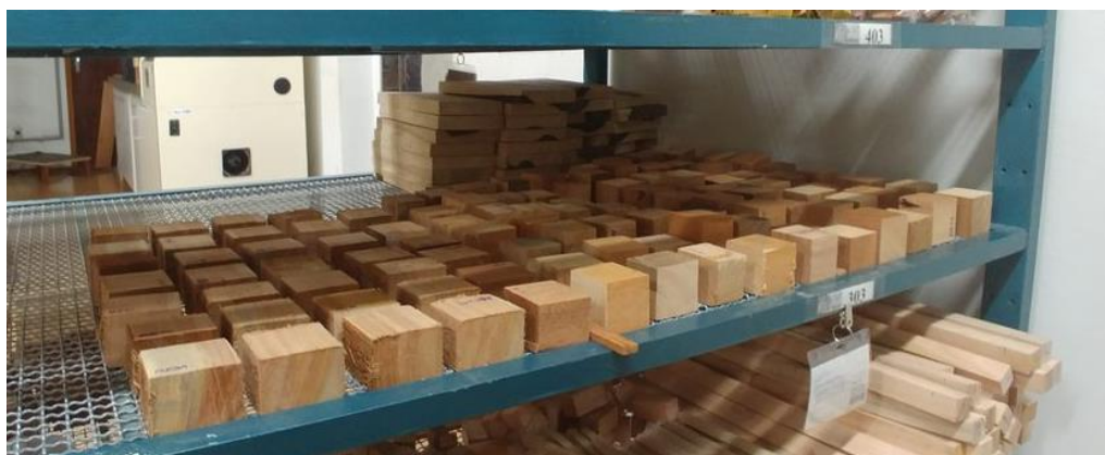
Figura 7 - Armazenamento dos corpos de prova em sala climatizada.
