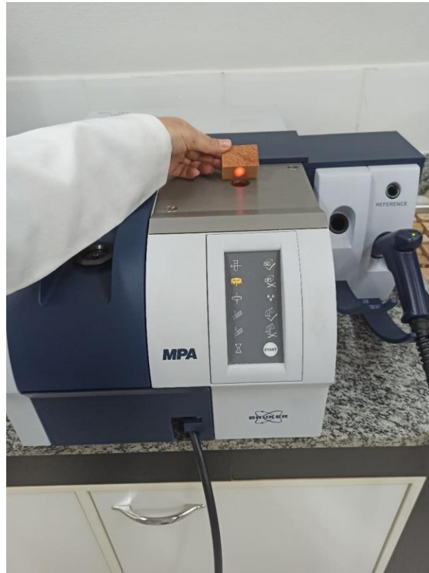
Figura 6 - Aquisição espectral no NIR via esfera de integração em espectrômetro NIR.
