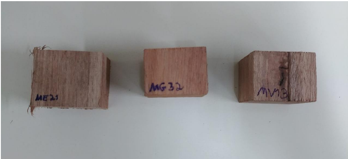
Figura 5 - Da esquerda para a direita: corpos de prova das espécies Erisma uncinatum , Guarea guidonea e Vochysia sp.
