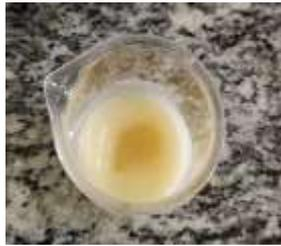
a- Solução de albumina, pectina e NaOH antes de ser submetida a agitação.
