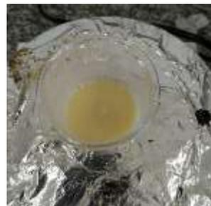
b- Solução de pectina após ser homogeneizada no agitador mecânico.
