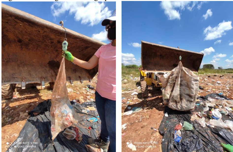
Figura 12 – Pesagem dos subgrupos com auxílio de uma retroscavadeira.
