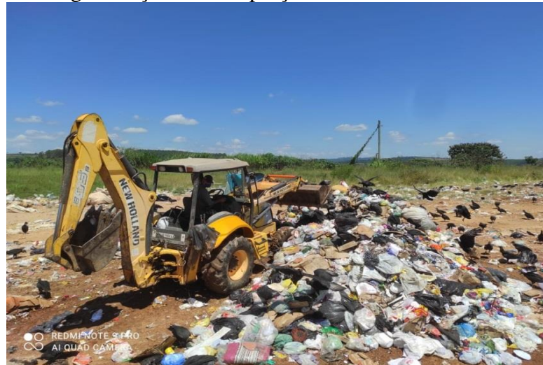
Figura 9 – Homogeneização de duas porções de 1/4 de resíduos sólidos urbanos.
