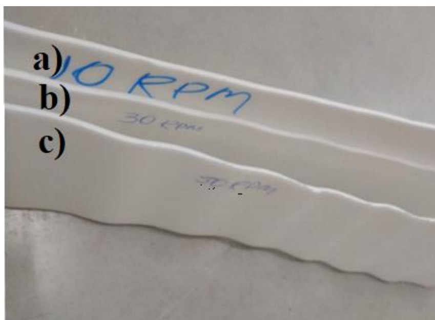
Figura 14: Ondulação apresentada no material. a) 0,57% de talco; b) 1,39% de talco; c) 2,21% de talco.
