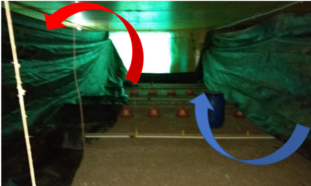
Figura 30 - Esquema de cortinas para a ventilação mínima na pinteira sem o vento frio incidindo nas aves - JBS/Sidrolândia
