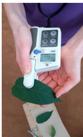
Figura 7. Mensuração com a ferramenta SPAD em uma folha saudável.
