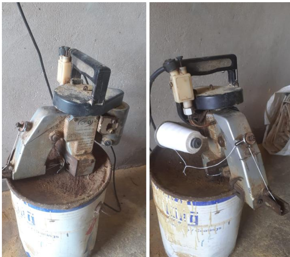
Figura 17 – Máquina de realizar a costura dos sacos contidos de sal proteico energético.
