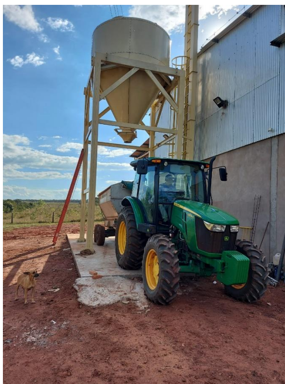
Figura 15 – Trator com vagão distribuidor acoplado, fazendo o carregamento no silo externo na fábrica de rações.
