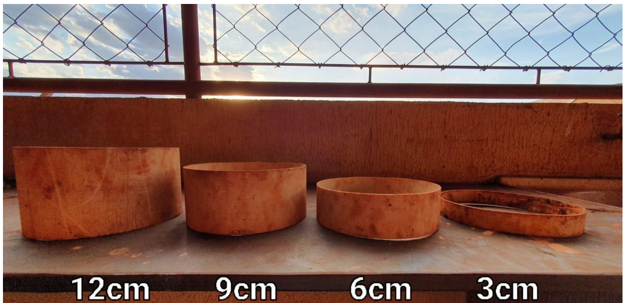
Figura 2 – Gabarito das profundidades de 3, 6, 9 e 12 cm.
