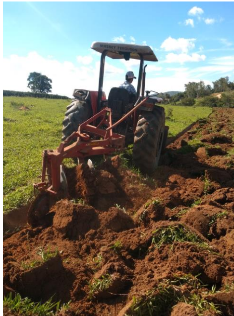
Figura 2 - Preparo do solo com o uso de arado de disco vista traseira.
