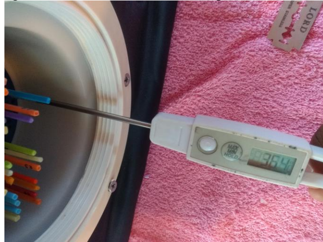
Figura 22 - Monitoramento da temperatura da estufa.
