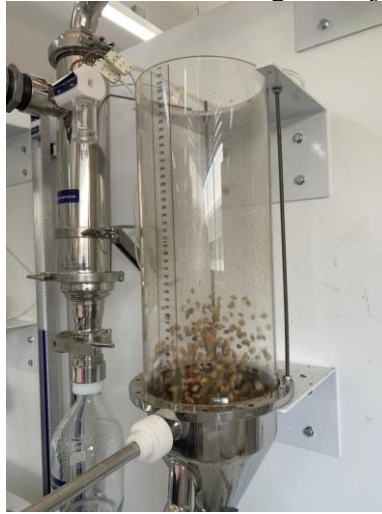
Figura 14 - Leito de secagem de jorro.
