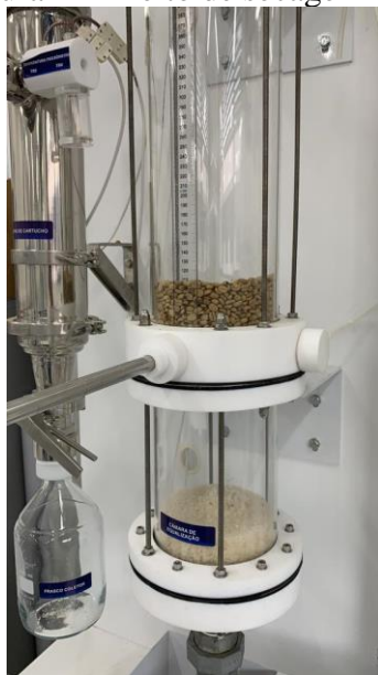
Figura 12 - Leito de secagem fixa.
