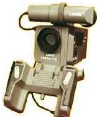
Figura 2: Termovisor resfriado eletricamente.
