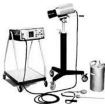
Figura 1: Termovisor resfriado a hidrogênio líquido.
