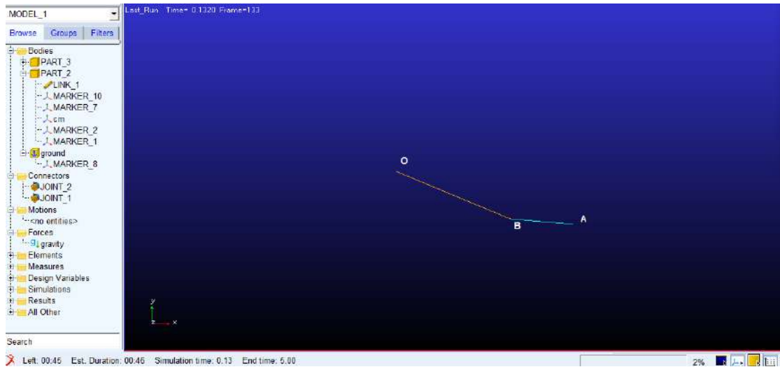
Figura 2.10 – Pêndulo duplo - simulação gráfica MSC Adams.
