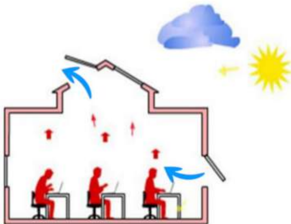
Figura 9 – Esquema de ventilação feita através de uma abertura lateral e uma no topo.
