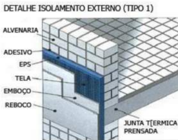
Figura 3 – Detalhamento Alvenaria com EPS
