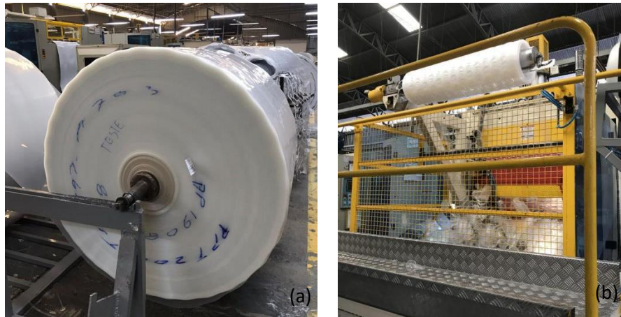
Figura 7: Produção das bobinas e termoformagem dos copos. (a) bobina extrudada; (b) bobina no processo de termoformagem.
