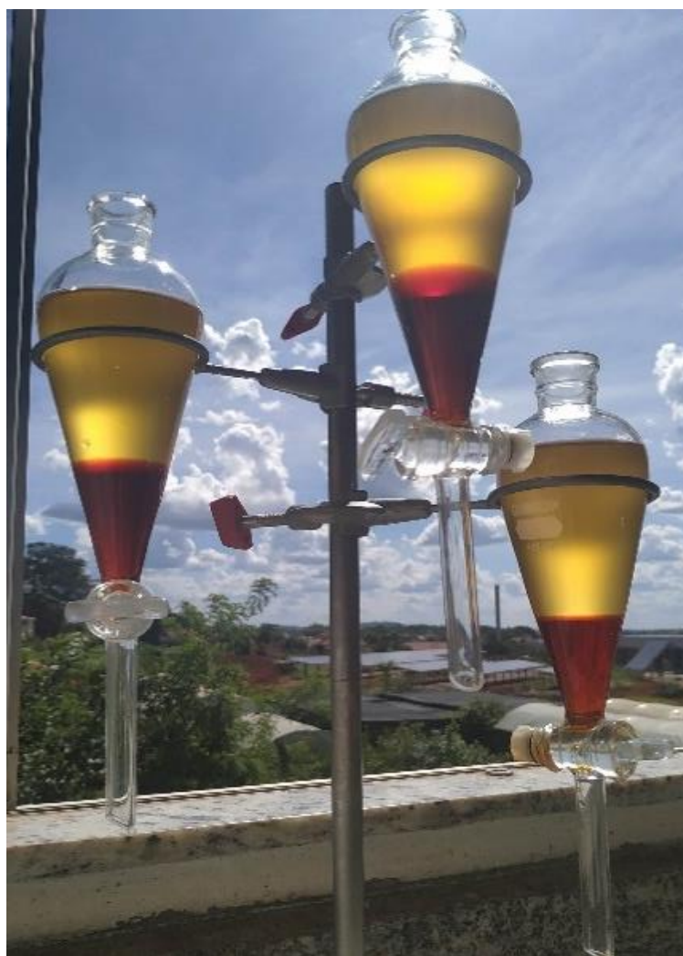
Figura 10- Decantação para separação de biodiesel do glicerol.
