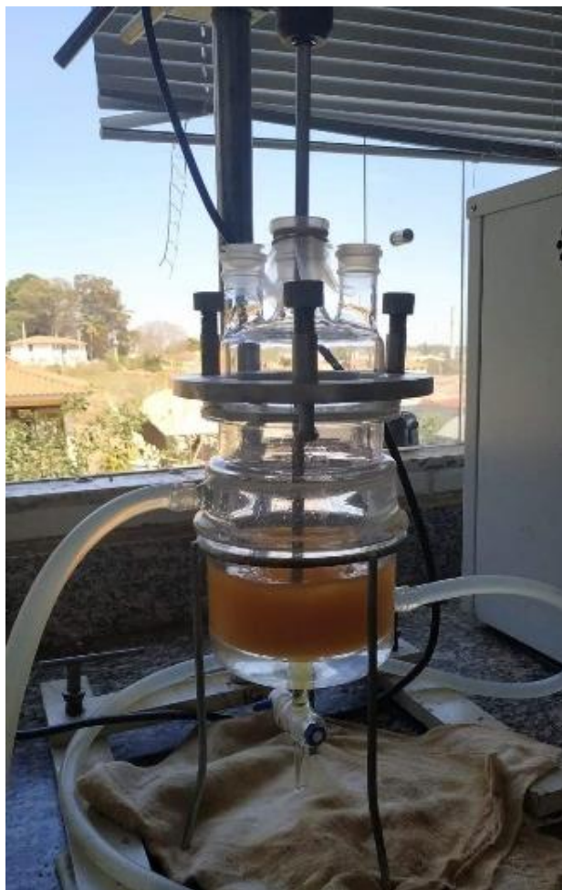
Figura 9- Reator de vidro encamisado.
