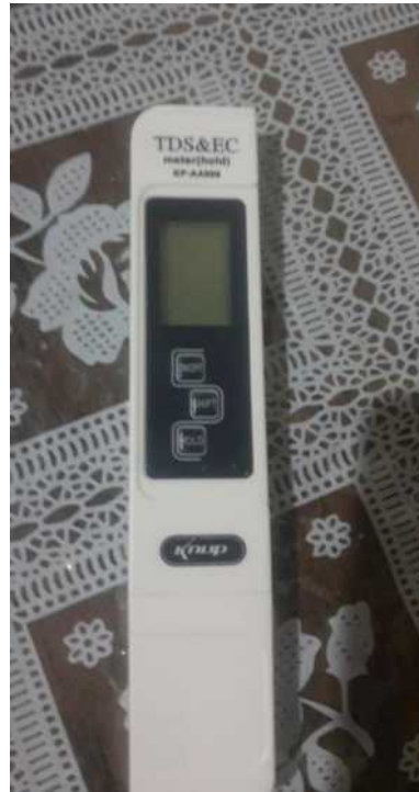
Figura 1 – Medidor condutivímetro utilizado para análise de parâmetros físicos da água (temperatura, condutividade elétrica e sólidos totais dissolvidos).
