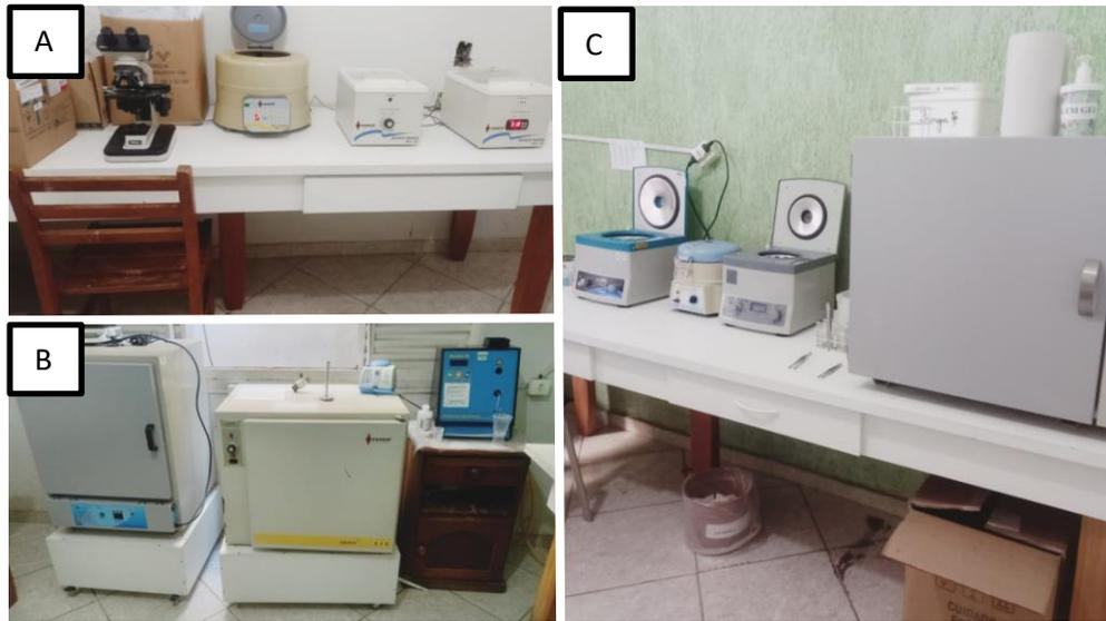
A: dois banhos-maria, uma centrífuga para tubos de ensaio e microscópio para análise coparassitológica. B: estufas para secagem de materiais e fotômetro de chama. C: duas centrífugas de tubos capilares, uma centrífuga de tubos de ensaio e uma estufa para cultura bacteriana. (Arquivo pessoal, 2021.)
