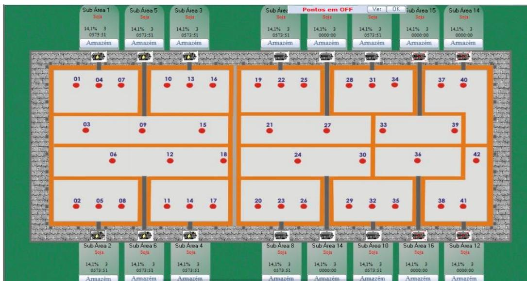
Figura 12 – Croqui de disposição dos cabos no Armazém – Central Air Master, Fockink
