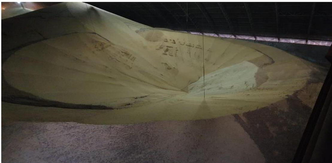
**Figura 9 – Concentração de vagens e palhas nas extremidades do armazém – Bunge Cascavel**
