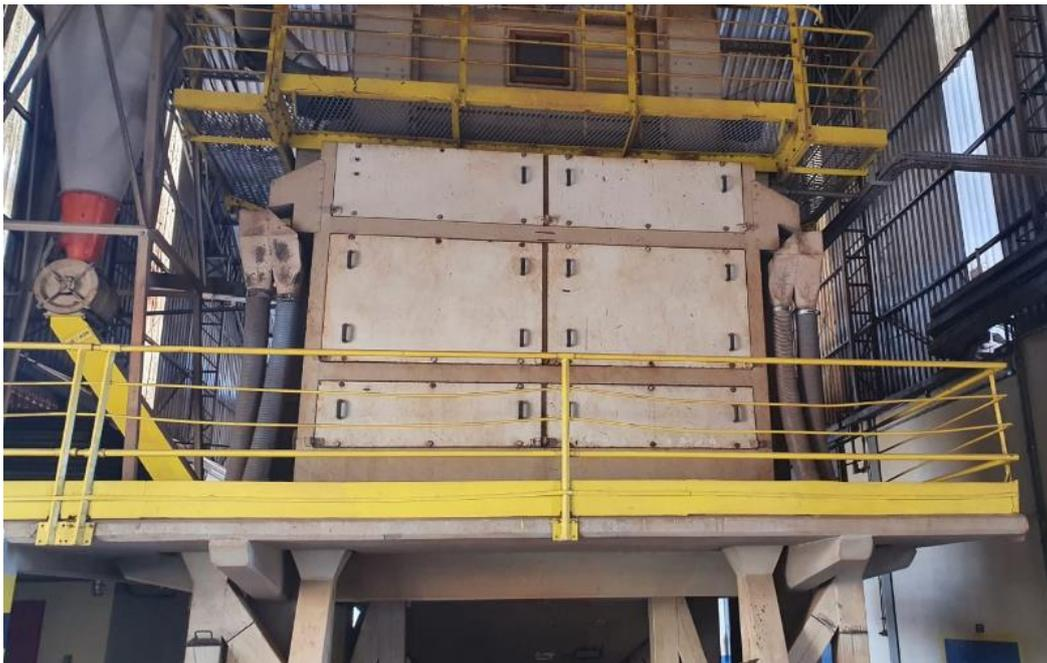
**Figura 1 – Máquina de Pré-Limpeza TMSA PL 40A – Otávio Campos, Bunge Cascavel**
