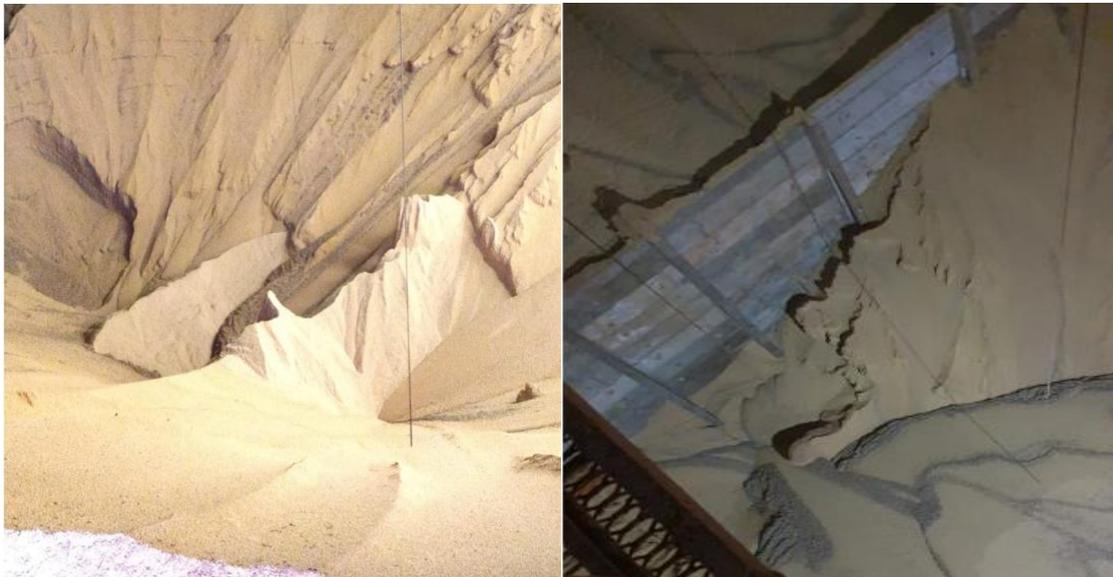
**Figura 8 – Torrões de soja no armazém formado pela compactação do produto – Bunge Cascavel**
