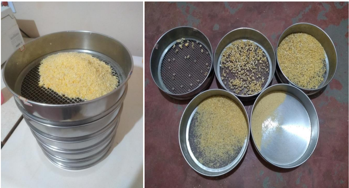
Figura 17- Peneiras para avaliação da granulometria do milho.
