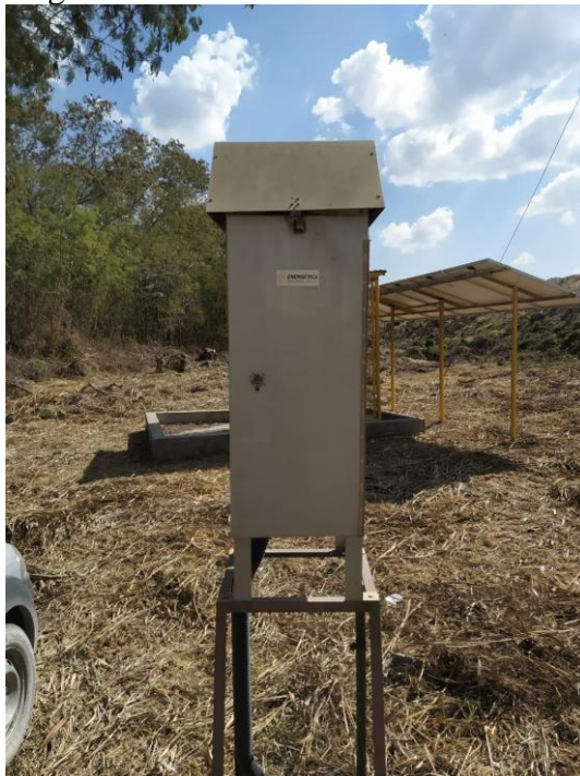
Figura 9 - Hi-Vol na montante da mina.
