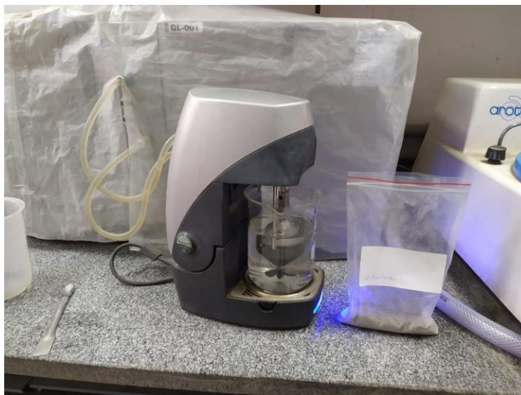
Figura 7 - Mastersizer 3000E e amostra de particulado.
