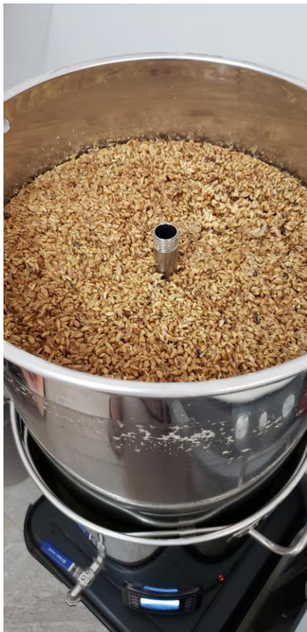
Figura 18 – Lavagem dos grãos e retirada do malte da American Pale Ale .
