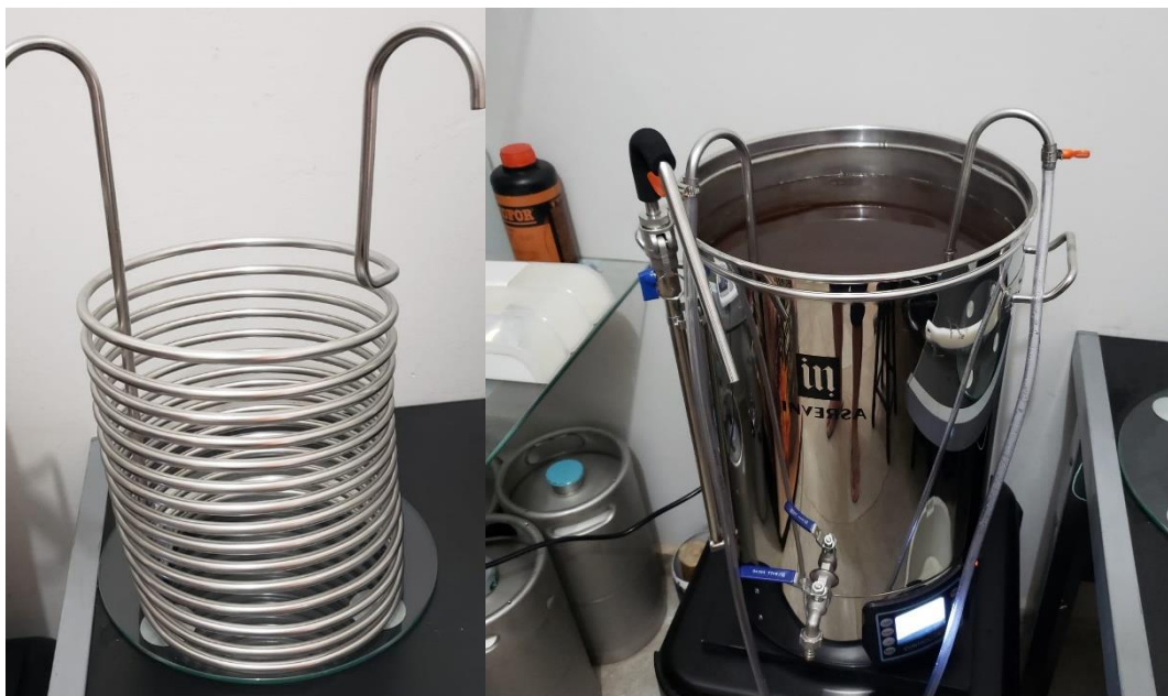
Figura 10 – (a) Trocador de calor externo e (b) trocador de calor interno.
