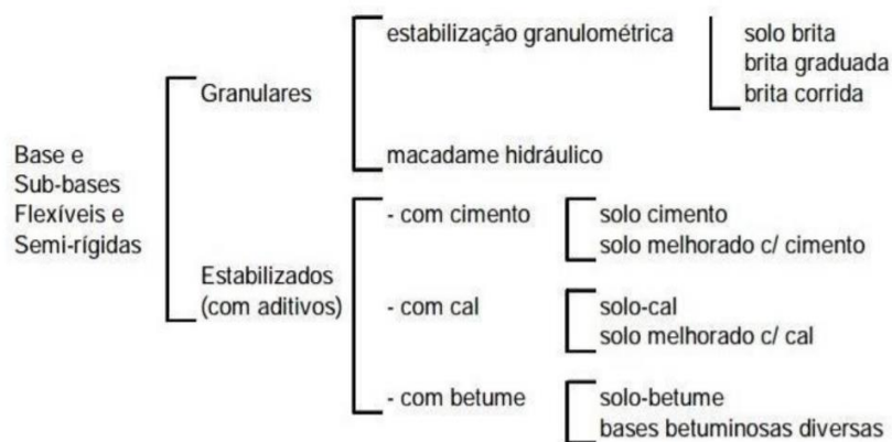
Figura 6 – Classificação das bases e sub-bases
