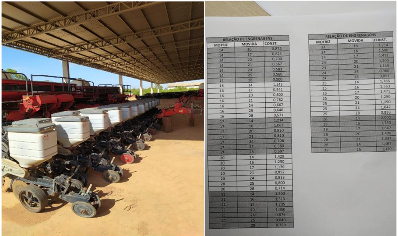
Figura 8 – Caixa de engrenagens e combinação das engrenagens motriz e movida.
