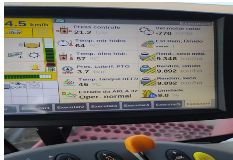
Figura 22 – Painel para alterar a configuração da colhedora.
