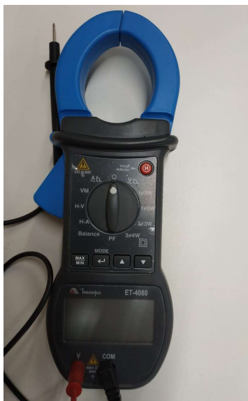
Figura 15 – Wattímetro utilizado para aquisição da potência
