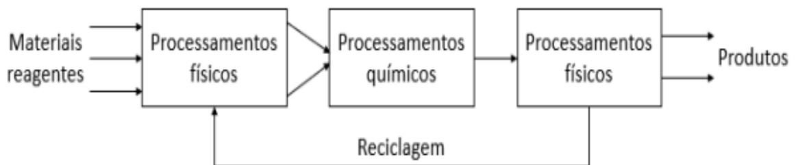
Figura 6 - Diagrama de blocos de um processo químico.
