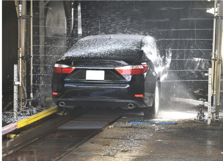
Figura 2 – Lavagem de carro do tipo “Túnel” através de jatos de alta pressão.
