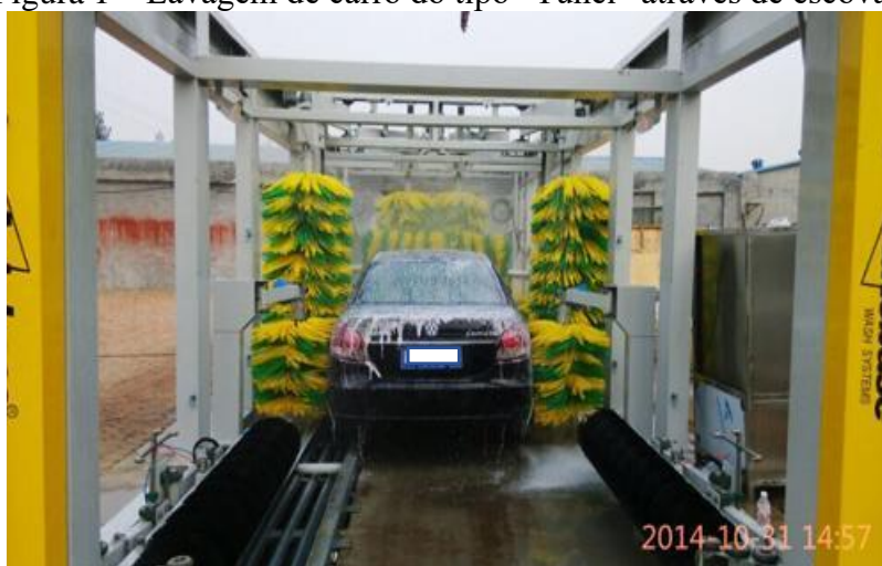
Figura 1 – Lavagem de carro do tipo “Túnel” através de escovas.
