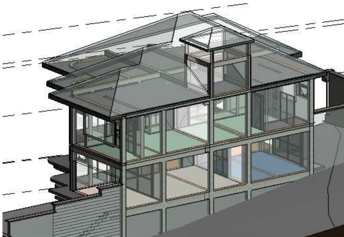
Figura 5.10 – Modelo arquitetônico e estrutural.
