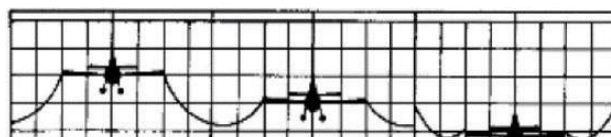
Figura 3.8 – Variação dos vórtices de ponta da asa
