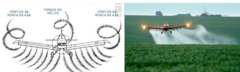
Figura 3.6 – Vórtices gerados na ponta de asa e pelo torque da hélice
