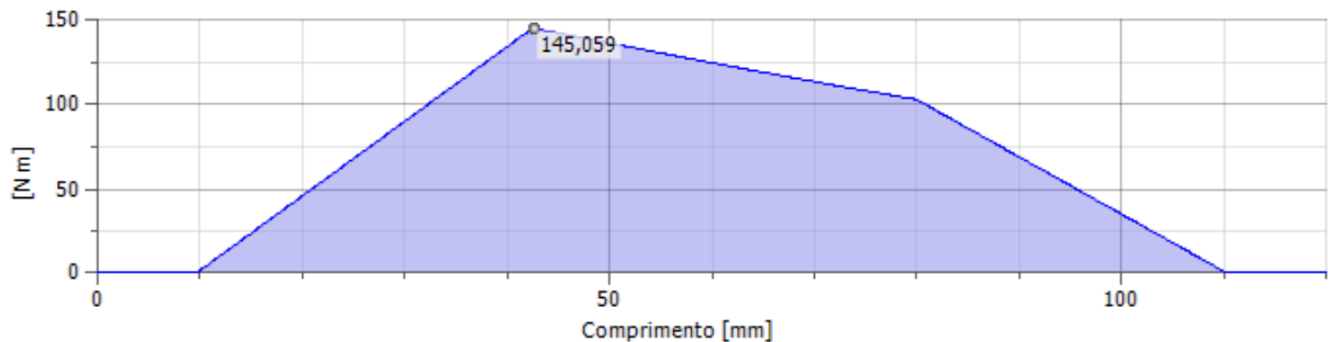
Figura 4.9 – Diagrama de momento fletor (eixo intermediário)
