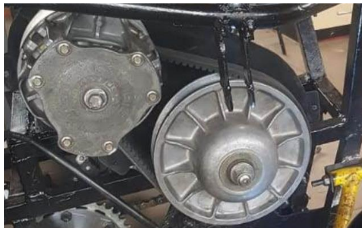
Figura 2.1 – CVT Polaris P90 – Protótipo da equipe Buffalo Baja, 2018.
