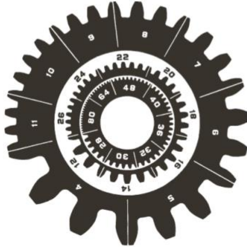
Figura 2.7 – Representação do tamanho do dente em função do passo diametral.
