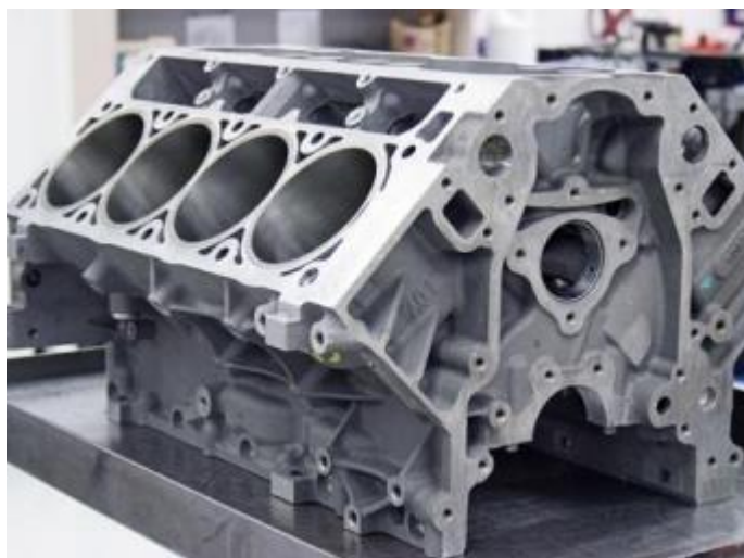
Figura 3.2 - Bloco de motor em liga A356 Chevy LS7: big smallblock.
