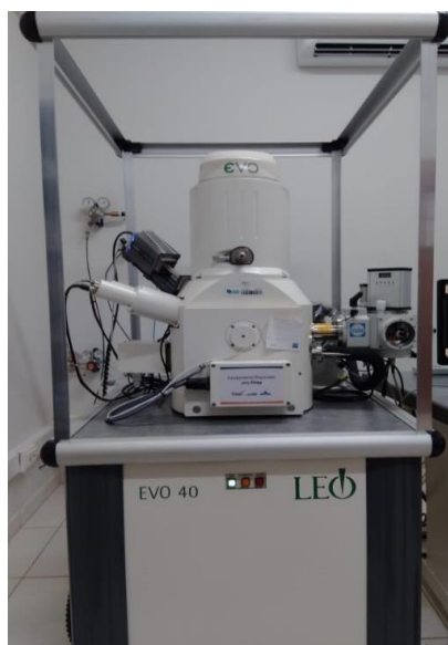
Figura 4.10 – Equipamento MEV utilizado, com EDS acoplado.
