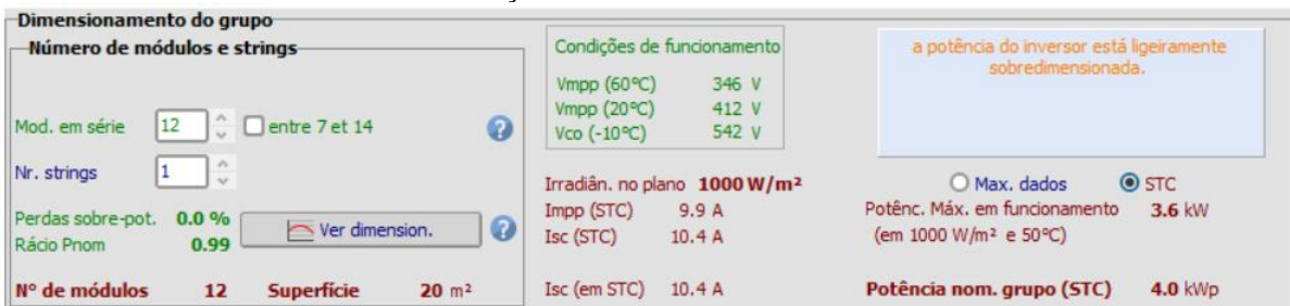
Figura 3.10 - Parâmetros de configuração do número e orientação de módulos fotovoltaicos, para as simulações do sistema fixo caso A e móvel
