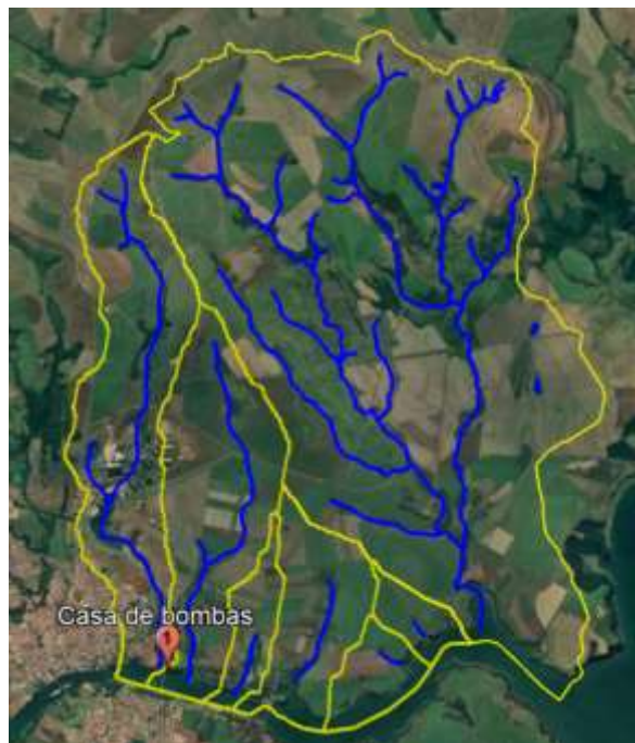
Figura 3 – Bacia de contribuição para o ponto de captação de água avaliado.
