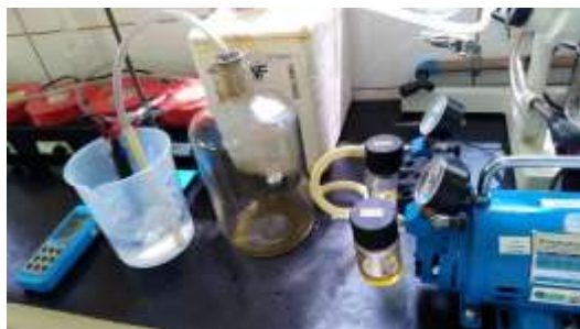
Figura 2: Processo de oxigenação da amostra do efluente pelo compressor de ar Primatec 2012
