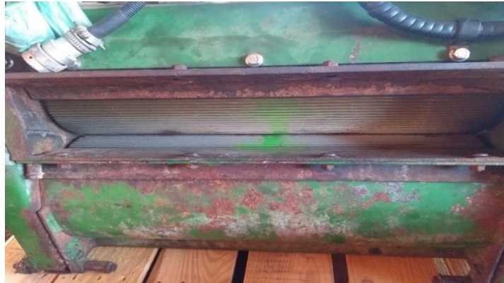
Figura 32. Processador de grãos com distância de 1 mm entre os rolos.
