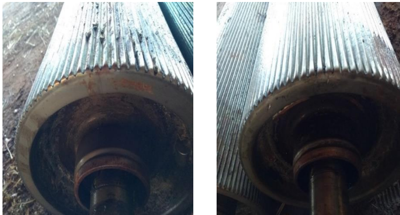
Figuras 31. Rolos do processador de grão com bordas bastante arredondadas.
