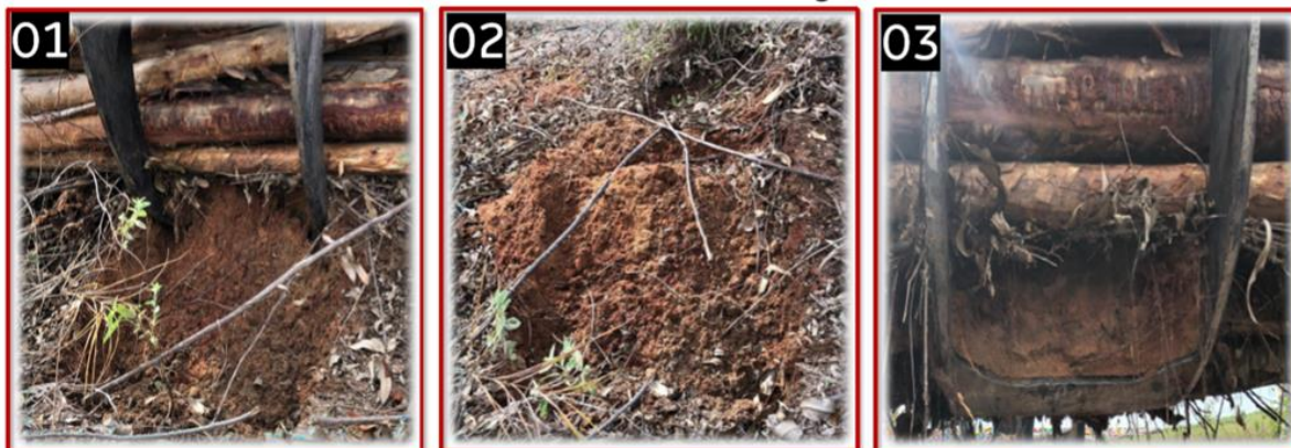
Figura 10: Garra com mandíbula no transporte de resíduos
