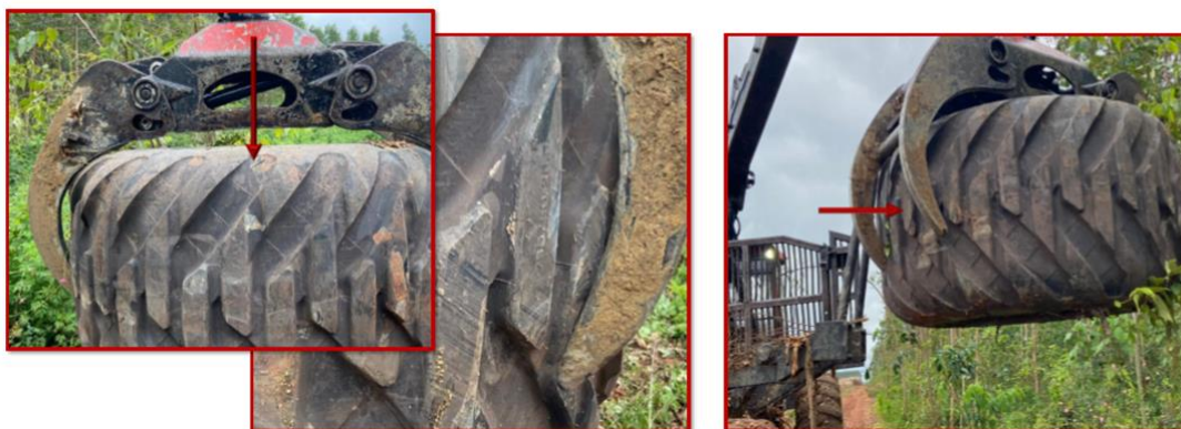
Figura 15: Técnica de movimento de pneus.
