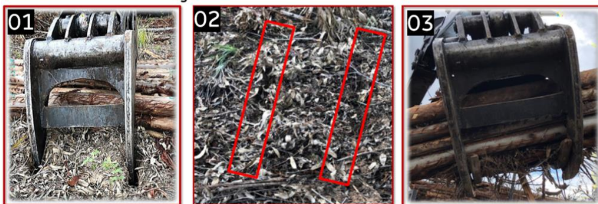
Figura 9: Garra sem mandíbula no transporte de resíduos
