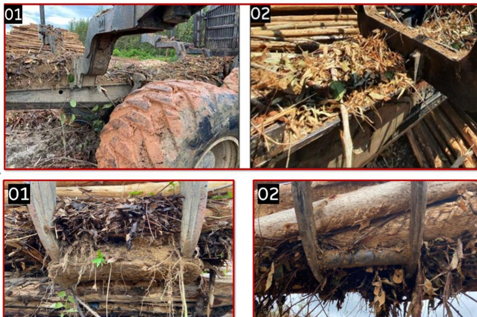
Figura: Imagens demonstrando a quantidade de resíduos nas diferentes garras.
