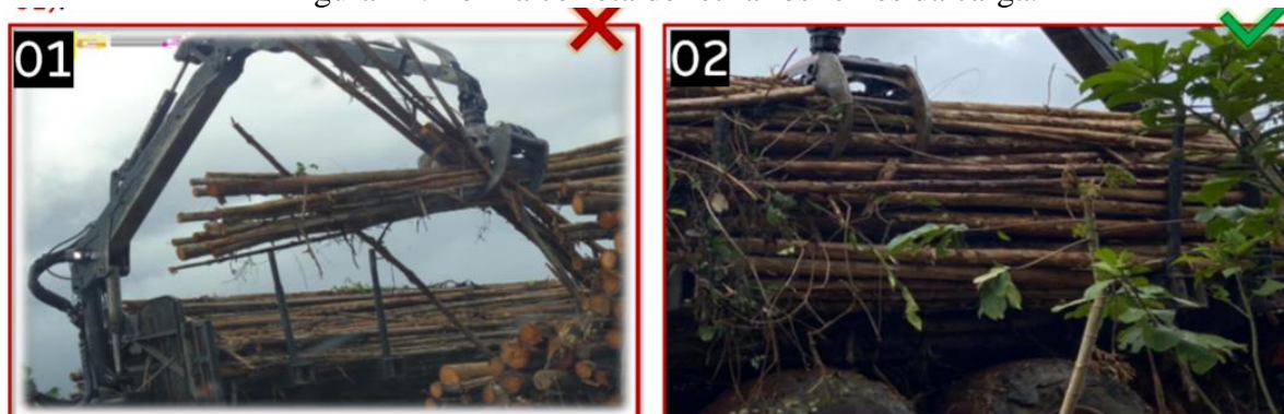
Figura 12: Forma correta de retirar os feixes da carga.
