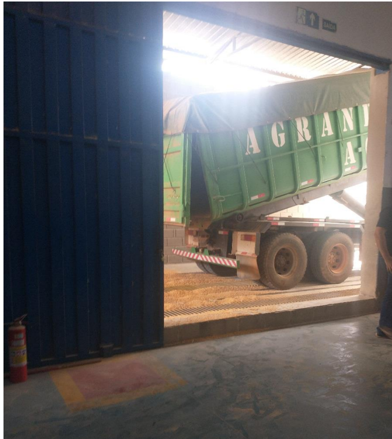
Figura 7 – Descarga do milho no foço. Caminhão basculante
