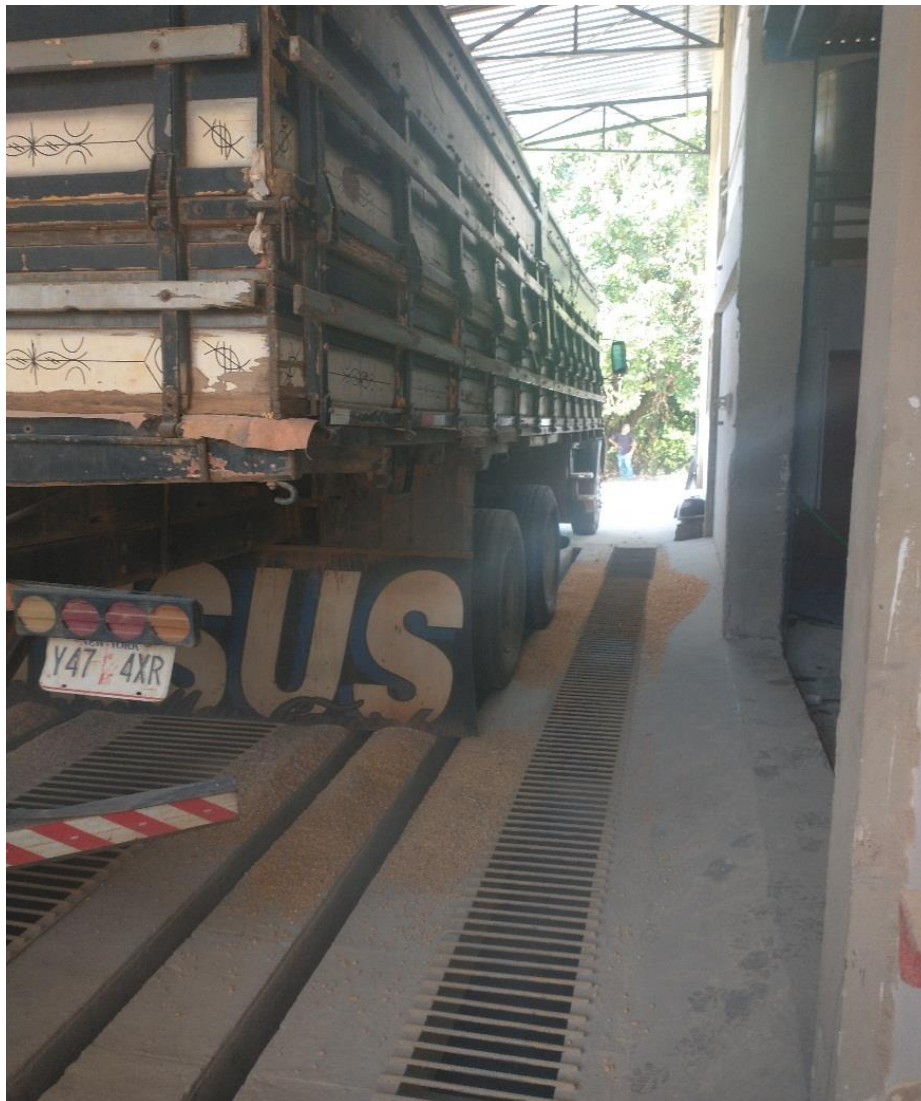
Figura 6 – Descarregamento do milho no foço. Caminhão tipo graneleiro
