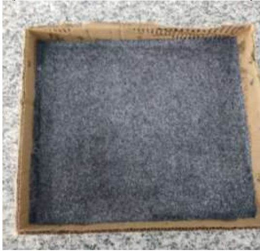
Figura 14 – Solução de carvão ativado e cola branca depositada na placa.
