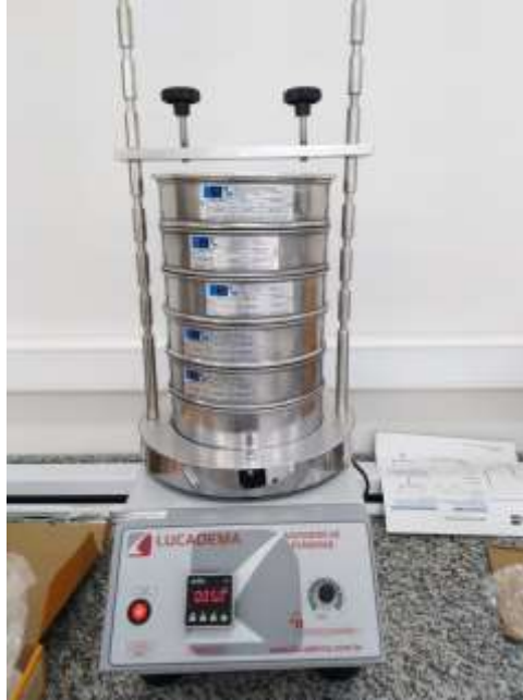
Figura 13 - Agitador de peneiras para análise granulométrica.
