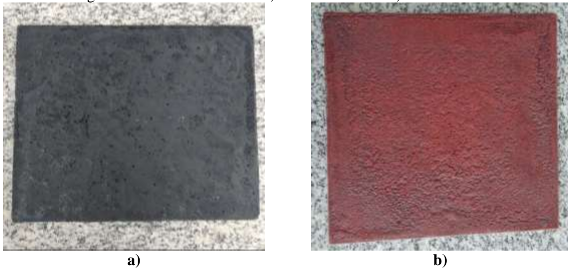
Figura 15 - Placa resistiva de a) carvão ativado e b) óxido de ferro.
