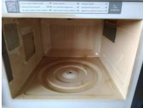
Figura 10 - Cavidade multimodo do forno micro-ondas.
