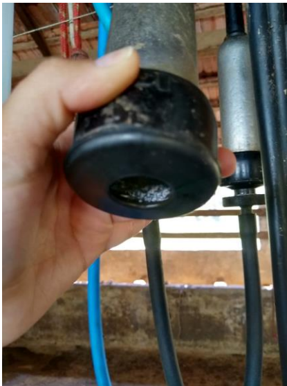
Figura 30- Exemplo de problema de limpeza de teteiras
