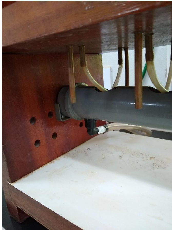
Figura 4 - Calha coletora da água proveniente do escoamento preferencial das amostras, abaixo da base principal onde se encontram as amostras.
