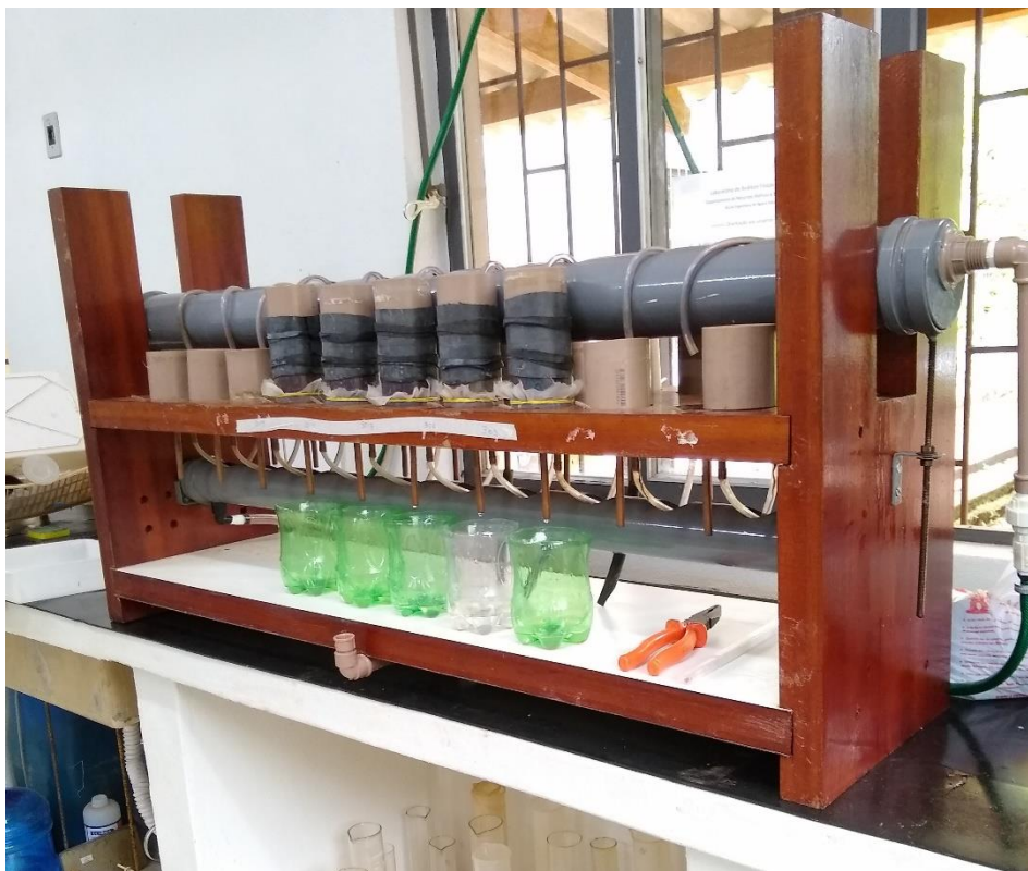
Figura 2 - Permeâmetro de carga constante, com detalhe das amostras utilizadas na avaliação da condutividade hidráulica saturada do solo.
