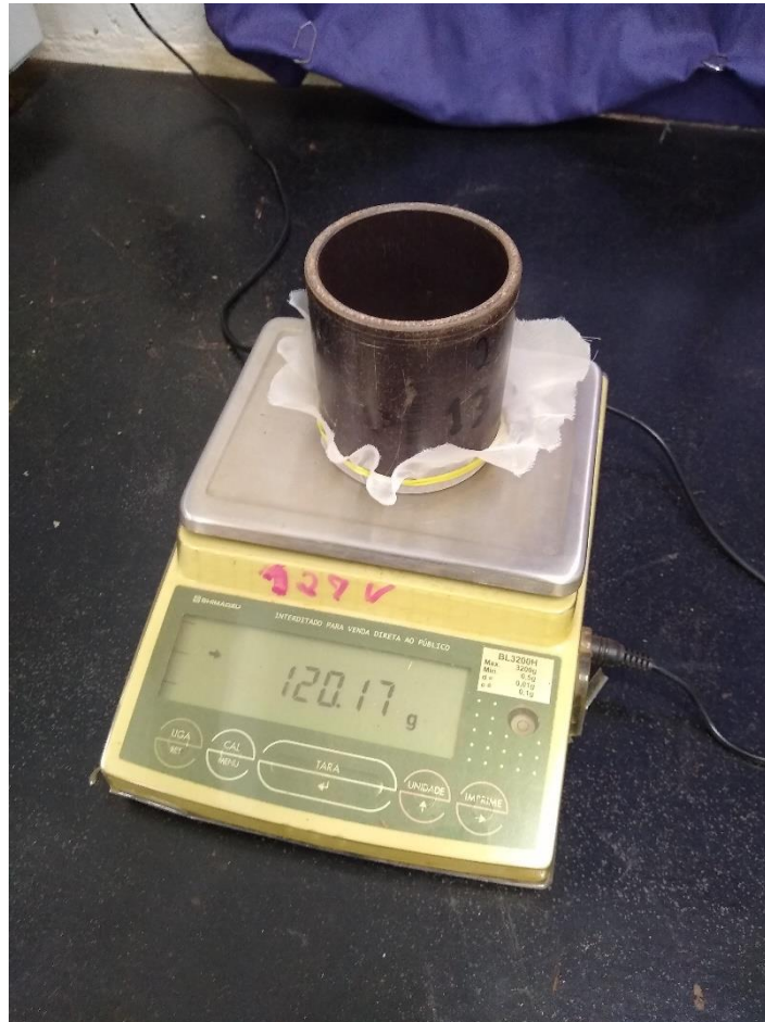
Figura 1: Amostra, com tecido sintético afixado com elástico na face inferior do cilindro.
