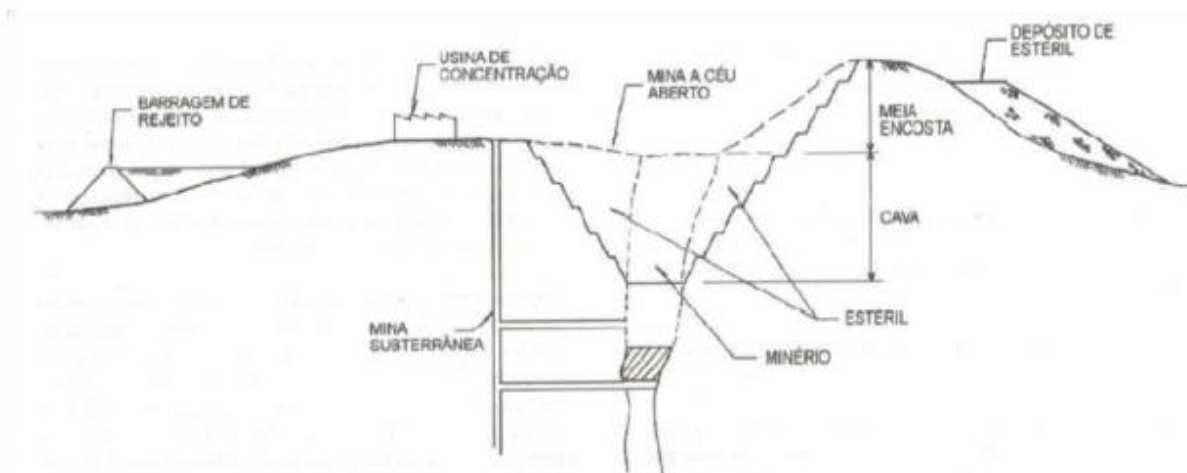
Figura 1: Esquema geral de um empreendimento de mineração
