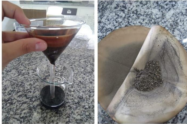
Figura 14 - Filtração das nanopartículas de prata com o vidro bioativo.
