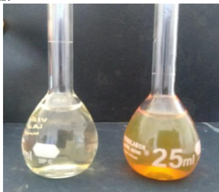
Figura 13 - Extrato puro e com as nanopartículas, respectivamente, diluídos 25 vezes para espectroscopia UV-Vis.
