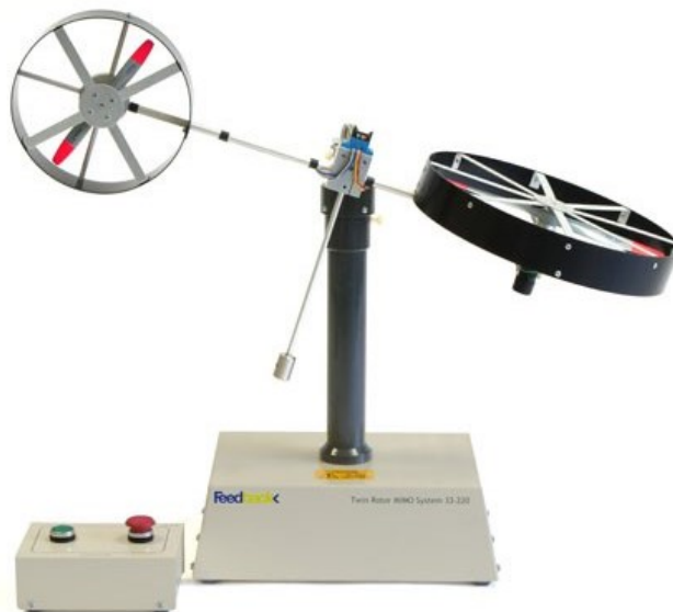
Figura 1.1 – Exemplo de bancada didática TRMS.
