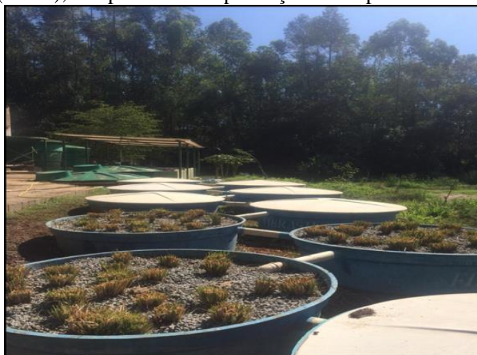
Figura 17- Sistemas alagados construídos de escoamento horizontal subsuperficial (SACs), na época de transplantação das espécies.
