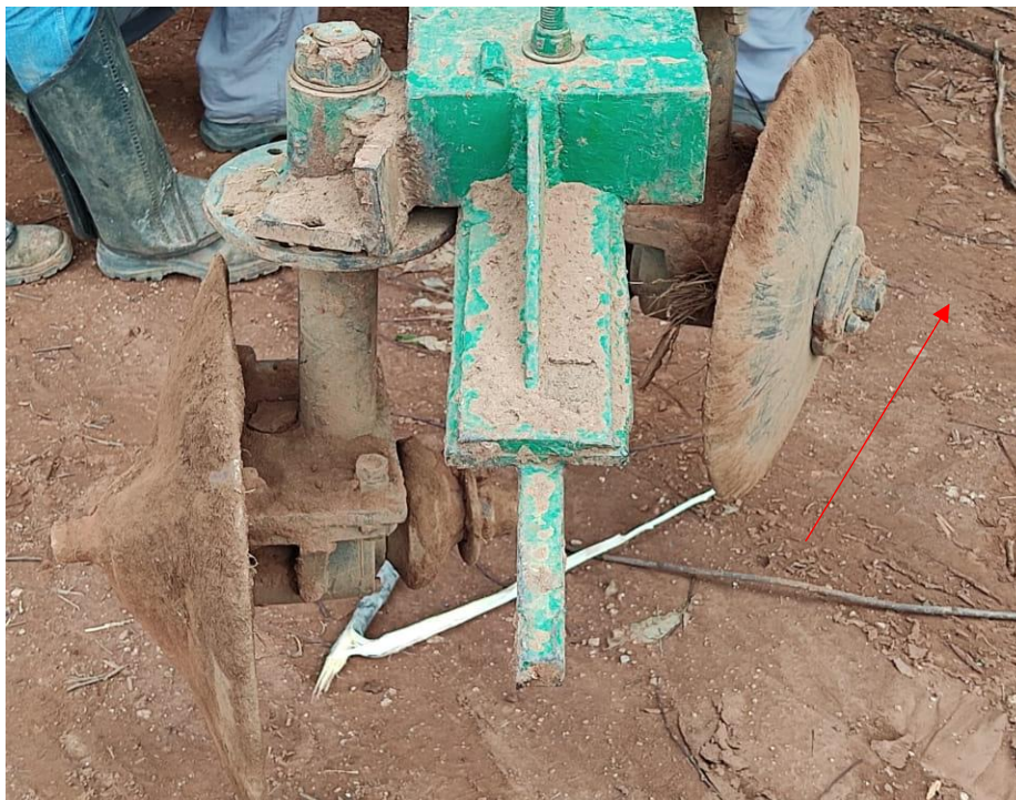
Figura 16 – Par de discos que formam o camalhão.
