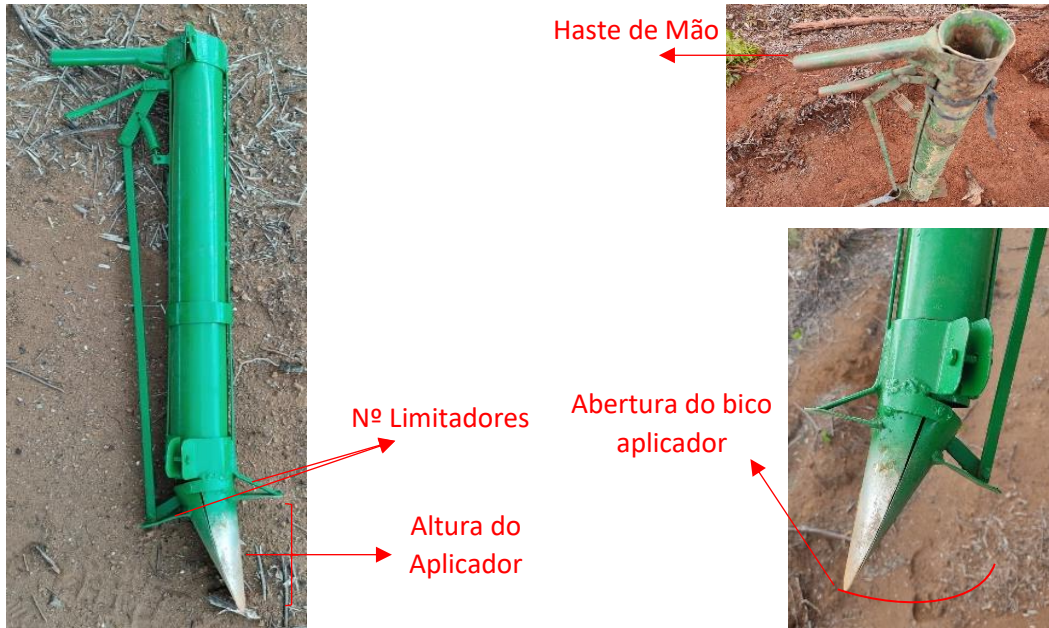
Figura 18 – Matraca para plantio de mudas e suas peças a serem padronizadas.
