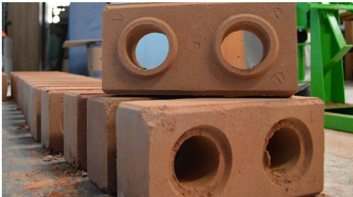
Figura 3- Tijolo de solo-cimento modular de 2 furos.
