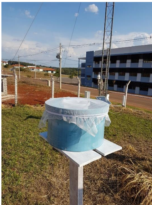
Figura 2 – Aparato experimental: Coletor de Deposição Total Atmosférica.
