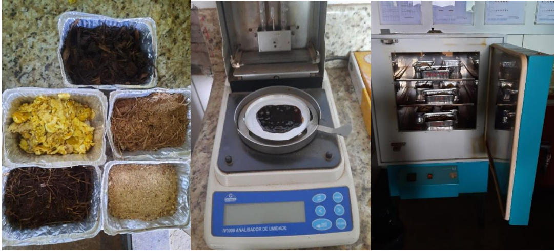
Figura 13- Amostras, Gehaka e Estufa utilizados na aferição da matéria seca dos alimentos.
