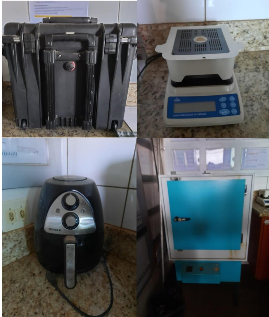
Figura 5- AgriNir, Gehaka, Airfryer e Estufa usados nas análises dos insumos
