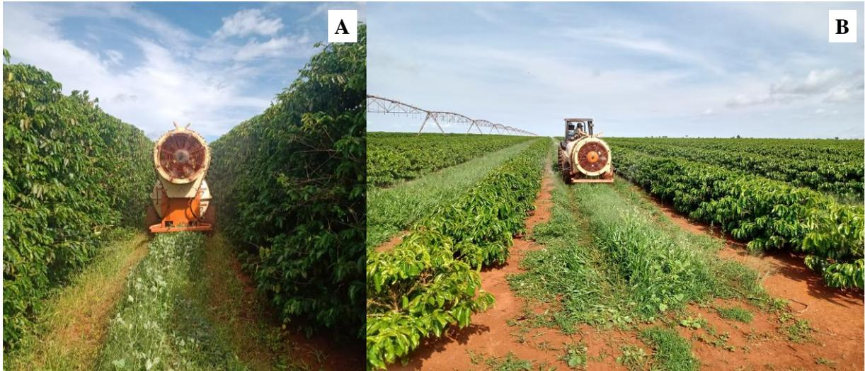
**Figura 10.** Detalhe da pulverização realizada por um atomizador tratorizado do tipo turbina baixa (A). Detalhe de um atomizador tratorizado do tipo turbina alta. Fonte: O autor.
