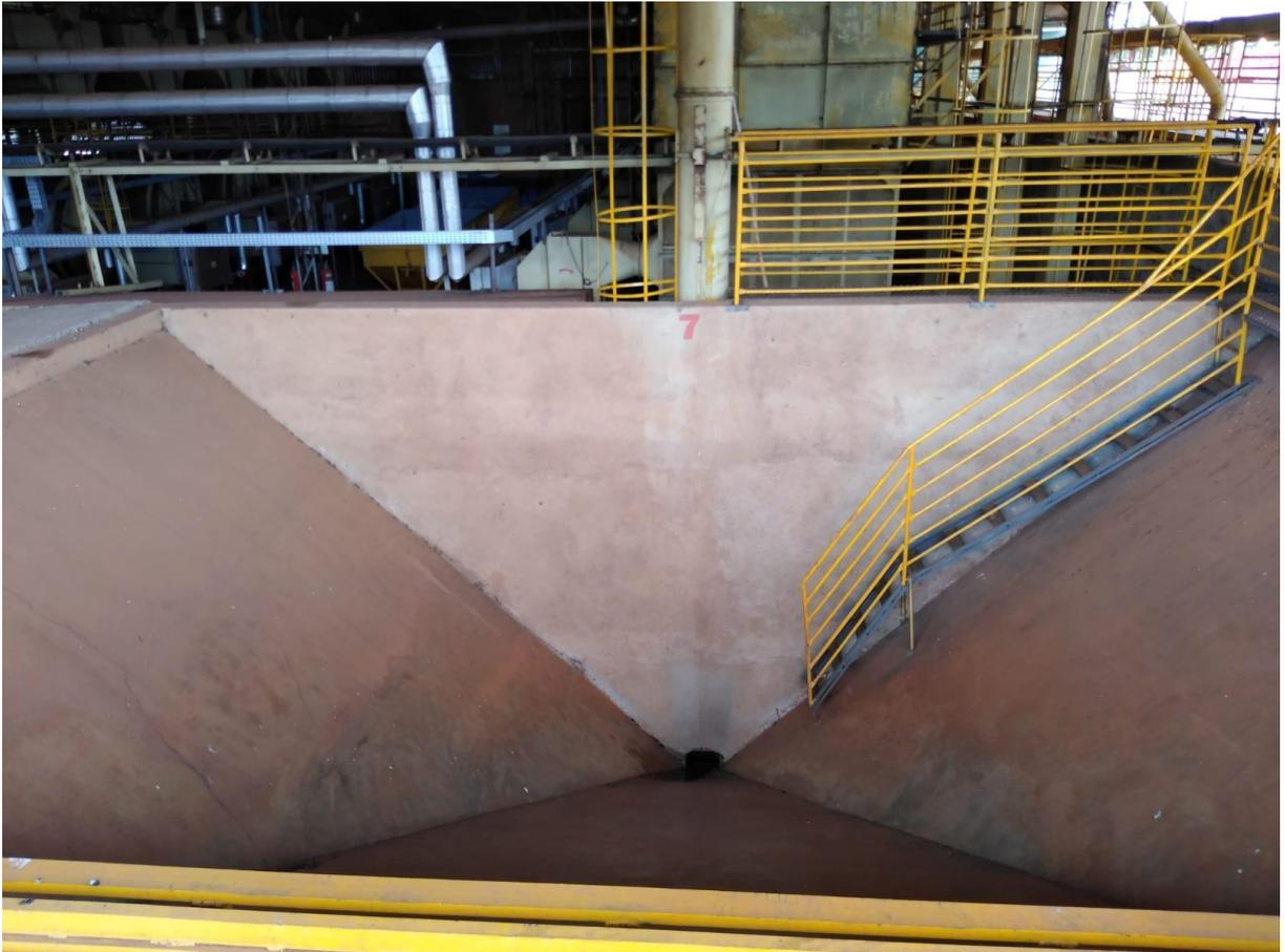
**Figura 6.** Detalhe da moega para recepção do café colhido. Fonte: O autor.
