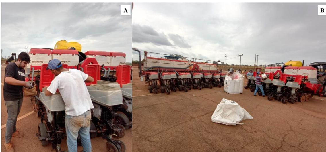
**Figura 20.** Imagem ilustrativa da caixa de sementes sendo alimentada com grafite (A); Detalhe das semeadoras sendo alimentadas com sementes de soja (B). Fonte: O autor.
