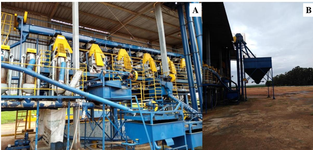
**Figura 7.** Detalhe do conjunto de peneiras para pré-limpeza do café e “benefício úmido” (A); Detalhe do reservatório do café já onde se realiza a primeira separação em: cereja, verde (B). Fonte: O autor.
